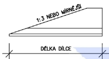
Obrázek 16 - Koncový díl betonového svodidla
